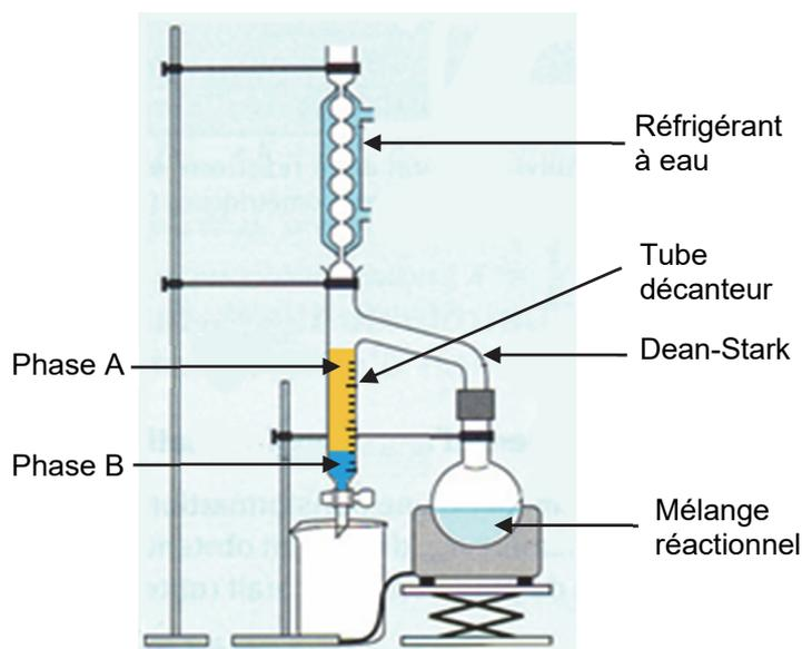
Figure 4. Schéma du montage avec dispositif Dean-Stark
