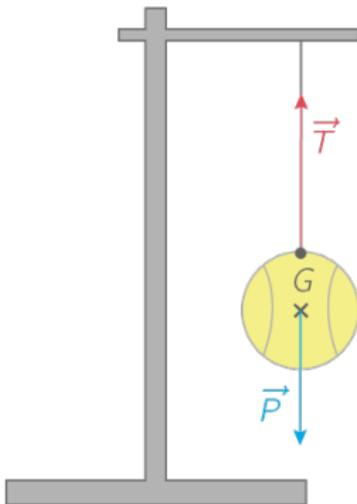
Dans cet exemple,  $\vec{T}$  est la tension du fil : c'est la force exercée par le fil sur la balle de tennis. Sa direction est verticale, son sens vers le haut, sa norme vaut  $0,57 \text{ N}$  (nous verrons plus tard comment la calculer) et son point d'application est le point d'attache du fil sur la balle (c'est l'endroit où s'exerce l'action mécanique du fil).
