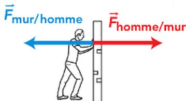
Dans cet exemple, l'homme s'appuie sur le mur. Il exerce donc une force horizontale **sur le mur**, orientée de gauche à droite et de norme  $F$ . En "réponse" à cette action de la part de l'homme, le mur exerce **sur l'homme** une force horizontale, orientée de droite à gauche et de même norme  $F$ .
