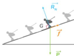
Un skieur descend une pente enneigée en ligne droite à vitesse constante. On en déduit que les forces auxquelles le skieur est soumis (poids, réaction normale de la neige, frottements) se compensent.
